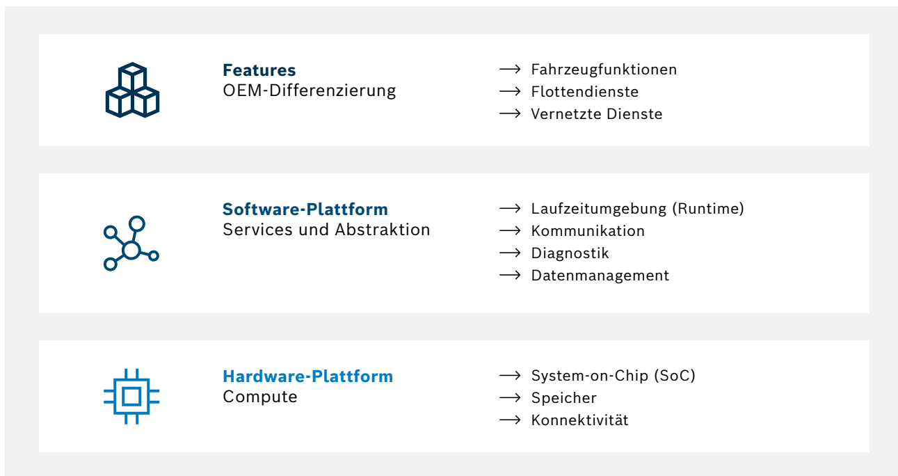
Abbildung 5: Eine vereinfachte, mehrschichtige Ansicht einer SDV-Plattform.
